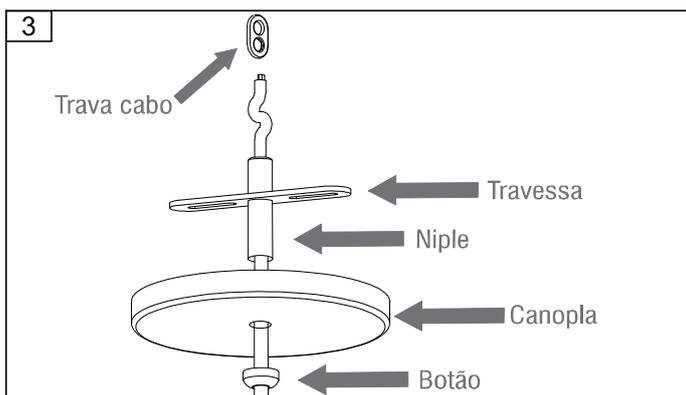
3º Passe o cabo do 08-SOQUETE+CABO, pelo 01-NIPLE, da 02-TRAVESSA e regule a altura do cabo com a ajuda do item 03-TRAVA CABO. Após o ajuste faça a ligação elétrica e rosqueie o 06-BOTÃO para travar a 04-CANOPLA.
