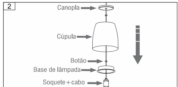
2º Encaixe as peças no 08-SOQUETE+CABO, conforme imagem acima.
